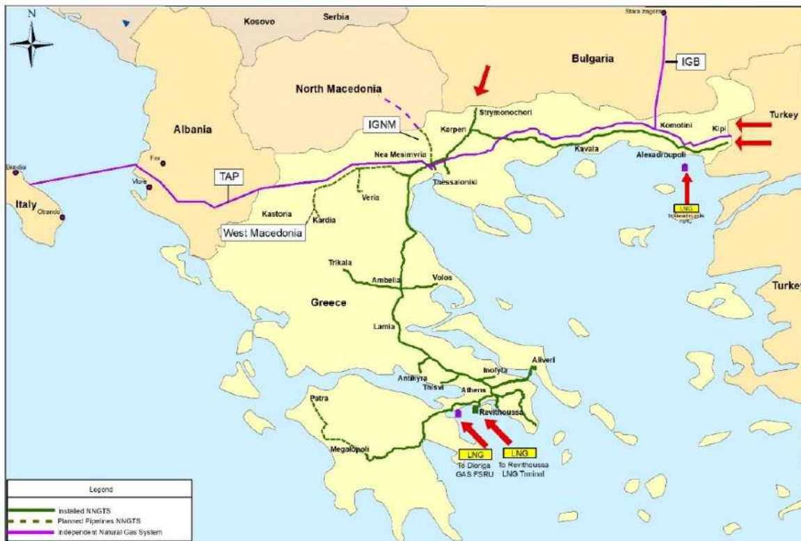
Εικόνα 1 Το ελληνικό σύστημα μεταφοράς φυσικού αερίου.
