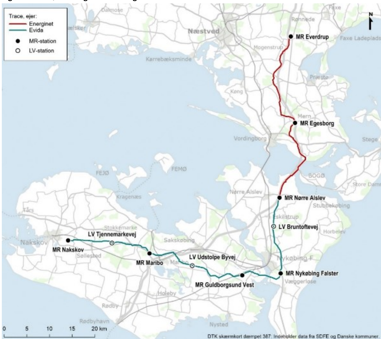
Figur 17. Gasrørledning til Lolland og Falster
